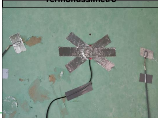
Termoresistenze superficiali interne Termoflussimetro
