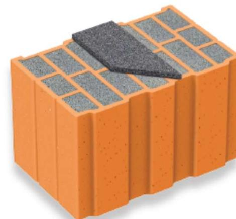
Il blocco in laterizio porizzato avente i fori saturati con polistirene additivato con grafite che garantisce valori di trasmittanza eccezionali uniti a valori di sfasamento e attenuazione tali da garantire il massimo comfort non solo in regime stazionario, ma anche in regime dinamico
