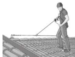
Esempio linea vita per operare in sicurezza in copertura.
