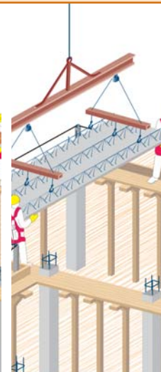
Solaio a lastre e blocchi in laterizio
