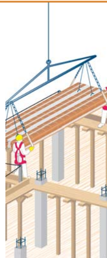
Solaio a pannelli in latero-cemento
