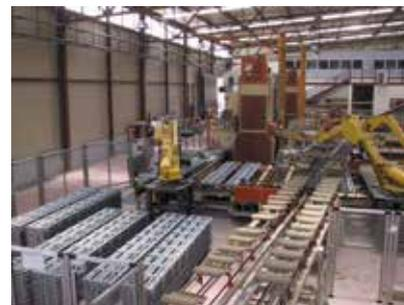
**Fig 1** Robot nella produzione di laterizi / Robot in the production of bricks
