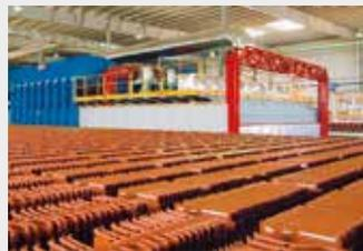
il rifacimento completo del sistema di movimentazione dei pianali di essiccazione delle tegole, incluso il trasporto sotto pressa (RAT) fino all'alimentazione delle tegole essiccate all'impianto di carico su carri fomo.
