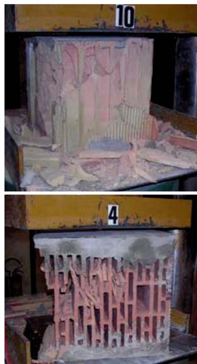
**Fig 2** Esecuzione di prove di compressione su elementi in laterizio con carico nella direzione: a)  $\perp$  al piano di posa; b)  $\parallel$  al piano di posa; / Performance of compressive strength tests on clay masonry units with load in direction: a)  $\perp$  to the installation plane; b)  $\parallel$  to the installation plane
