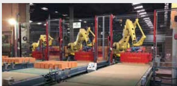
Capaccioli ha modificato la linea dello scarico cotto del suo cliente storico Kilsan (Turchia) rendendola completamente moderna e automatizzata grazie ai 3 robot che sono stati installati per alimentare la linea di packaging mettendo i singoli strati su 4 diversi nastri trasportatori. La linea è stata perfettamente collaudata già ad Ottobre 2018 e, grazie alle modifiche effettuate dalla Capaccioli, sono stati raggiunti i seguenti risultati:
