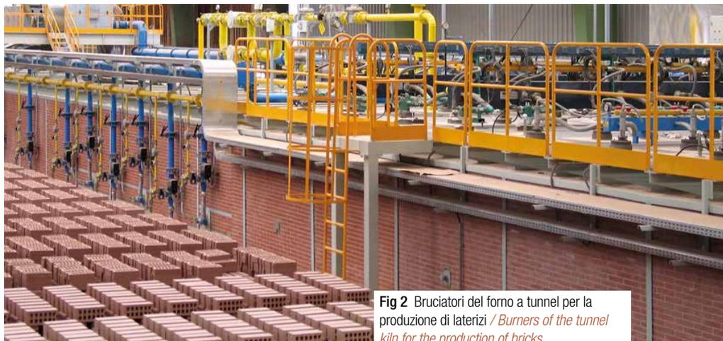
Fig 2 Bruciatori del forno a tunnel per la produzione di laterizi / Burners of the tunnel kiln for the production of bricks
