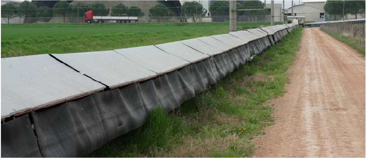
Nastro trasportatore per il convogliamento diretto dell'argilla allo stabilimento
